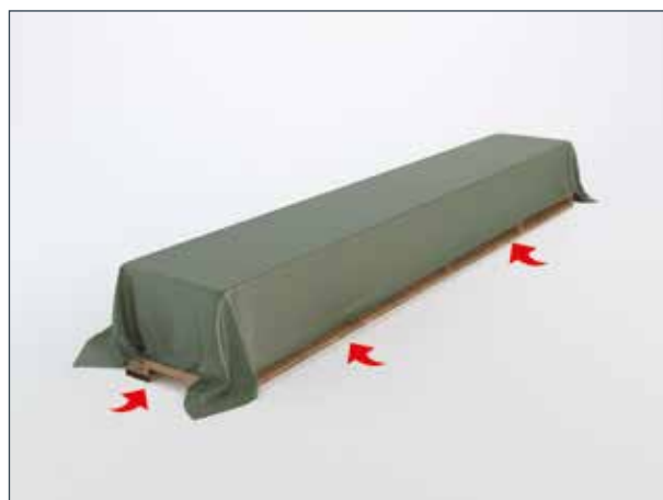
Förvara materialen under en torr och välventilerad presenning. Om produkten blir fuktig ska den ställas lodrätt på kant för att underlätta snabb torkning. Montera aldrig våta produkter.
